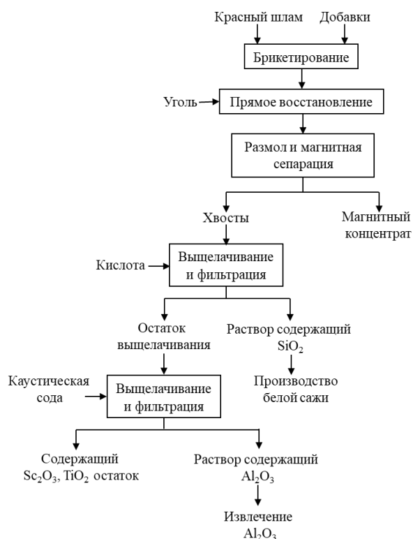
Рисунок – 8 Переработка красного шлама по схеме твердофазное восстановление-кислотное-щелочное выщелачивание
